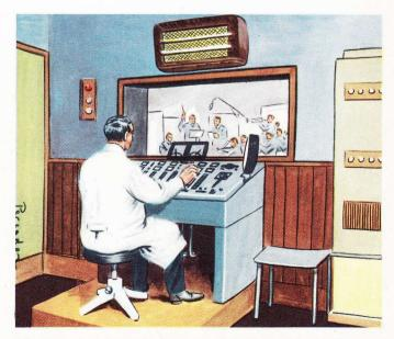
A la réception des ondes sonores, les micros les transforment en impulsions électriques pour les envoyer aux appareils de contrôle. Là, des techniciens et des régisseurs les « dosent » en connaissance de cause. A l'aide d'appareils spéciaux, le régisseur peut amplifier la résonance de l'orchestre ou la voix des chanteurs, afin d'obtenir une gamme variée d'effets musicaux.
